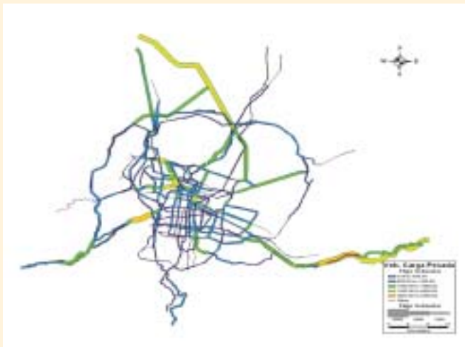
Figura 3. Flujo estimado de vehículos pesados de transporte de carga.
